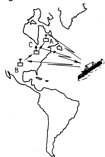
Fig. 3. - Localisation par stations fixes de réception et de calcul de coordonnées.
